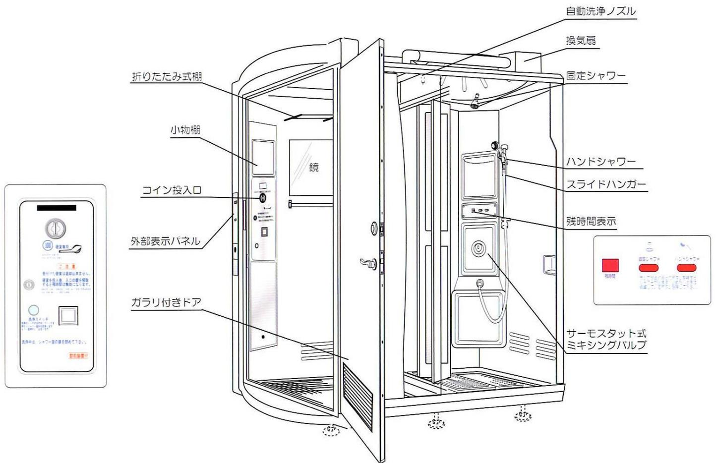
搬入設置後は給排水、換気、電源100Vの接続で運転可能
