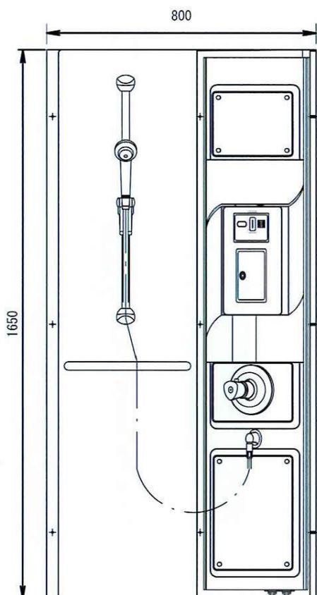
TP-94型はTP-64型の化粧カバー付きパネルタイプのコインシャワー。既存の給水・給湯配管を隠したい場合等簡単に施工ができます。
